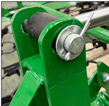
Säkra cylinder med sprint på cylindrefästet. (höger och vänster)
