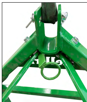
Dra hydraulslangar genom öglan för att hålla dem på plats.
