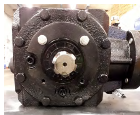
Lossa på skruvarna.
