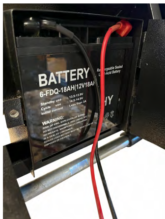
Batteriet är placerat bakom luckan under utkastarröret.
