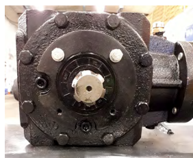
Lossa på skruvarna.
