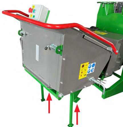
Bilden visar flishuggen i transportläge. Obs! Glöm ej att justera stödbenen, så de inte tar i marken under transport.
