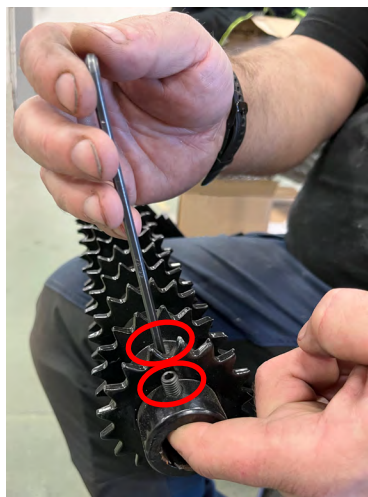
Skruva upp skruvarna ur kuggkransen.
